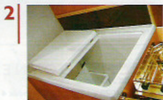
Komfortmaß. Das Kühlfach fasst 200 Liter. Anders als beim Prototyp (o.) ist der Deckel nun zweigeteilt
