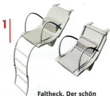
1 Faltheck. Der schön geneigte Spiegel öffnet partiell zur Bade- und Zugangsplattform
