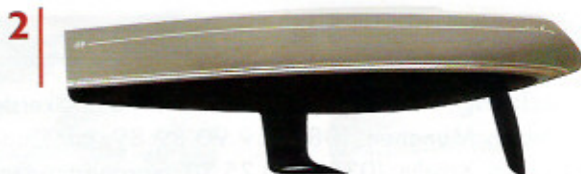
2 Unterwasserschiff. Der Entwurf von Mourtain & Mavrikios ist sehr leistungsorientiert, die Wasserlinienlänge überdurchschnittlich
